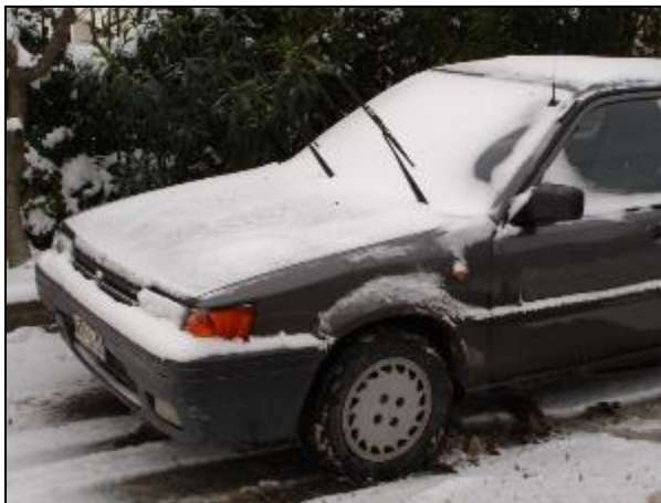
Εικόνα 28: Σε περίπτωση στάθμευσης σε χιονόπτωση, ανασηκώνουμε τα μάκτρα των καθαριστήρων, για να μην «κολλήσουν» κι ακινητοποιηθούν επί του ανεμοθωρακίου.
