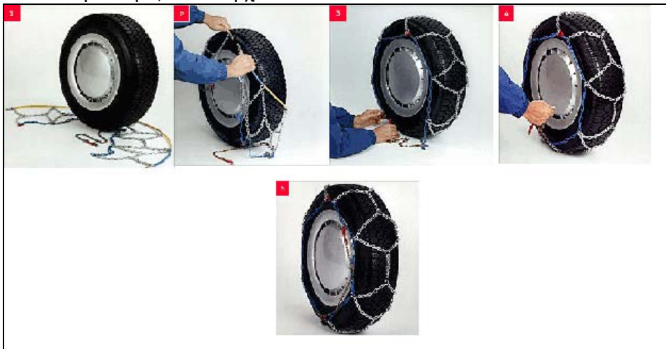
Εικόνα 27: Βήματα τοποθέτησης χιονοαλυσίδων.
