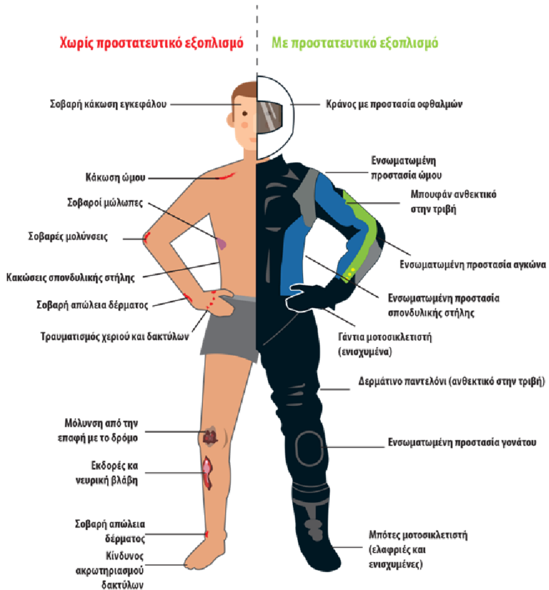
Εικόνα 11: Ένδυση μοτοσικλετιστή και τραυματισμοί που αποτρέπονται
