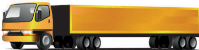
Σχήμα 2.8. Αρθρωτό όχημα με ελκυστήρα 3 αξόνων και διαξονικό ημιρυμουλκούμενο
