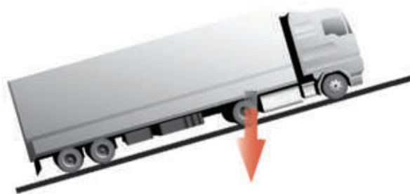
Σχήμα 2.26. Δύναμη βάρους σε ανωφέρεια
