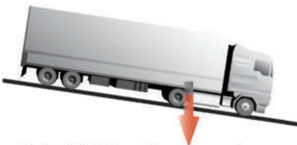
Σχήμα 2.27. Δύναμη βάρους σε κατωφέρεια
